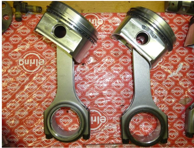
Schmiedekolben für 144mm H-Schaftpleuel Kolb-Motorsport
